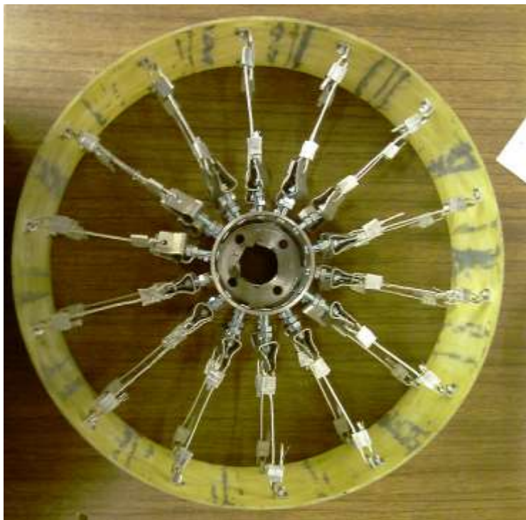
Рис. 5. Макет упругого стеклопластикового колеса
