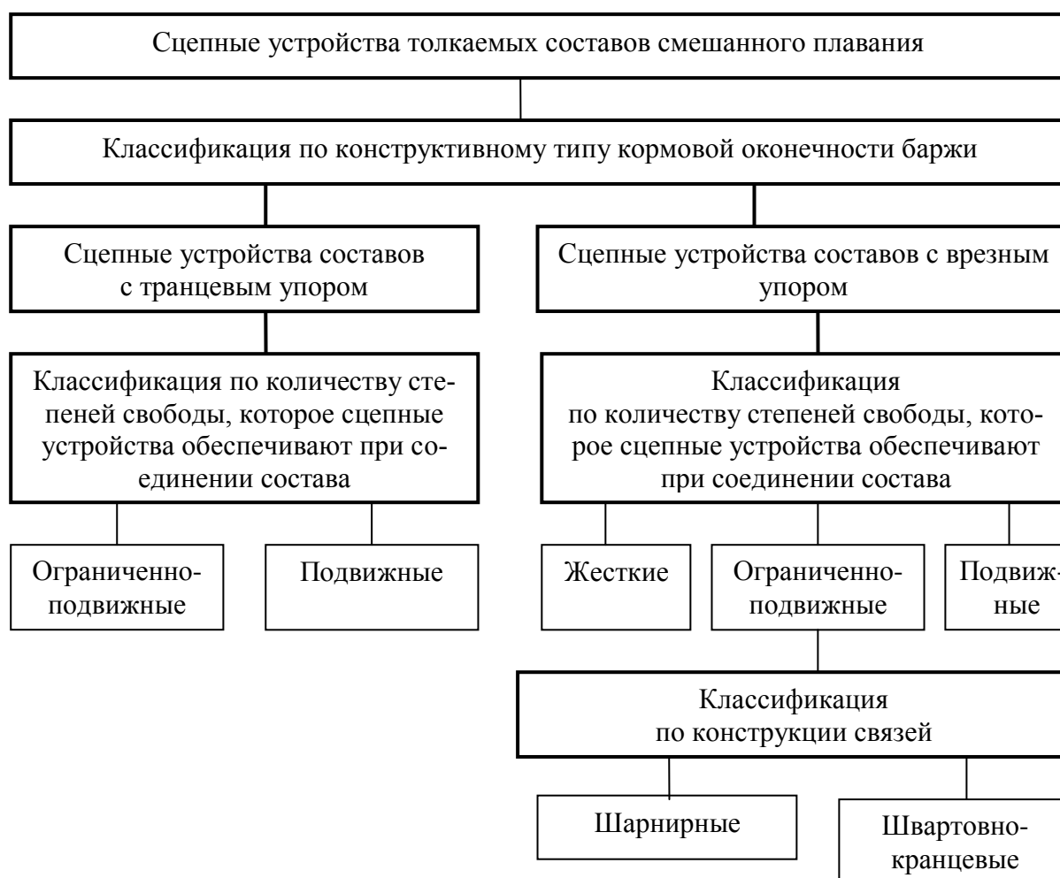
Рис. 3 Схема классификации сцепных устройств толкаемых составов
