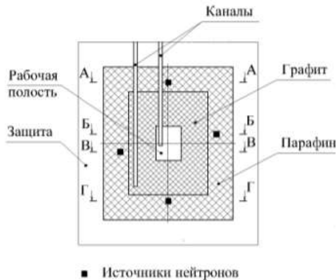
Рис. 1. Принципиальная схема универсального нейтронного конвертора
