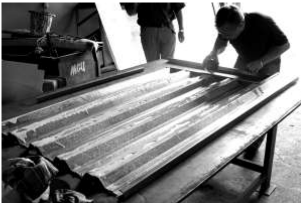
Рис. 5. Нанесение клея на внутренний гофрированный лист сэндвича
