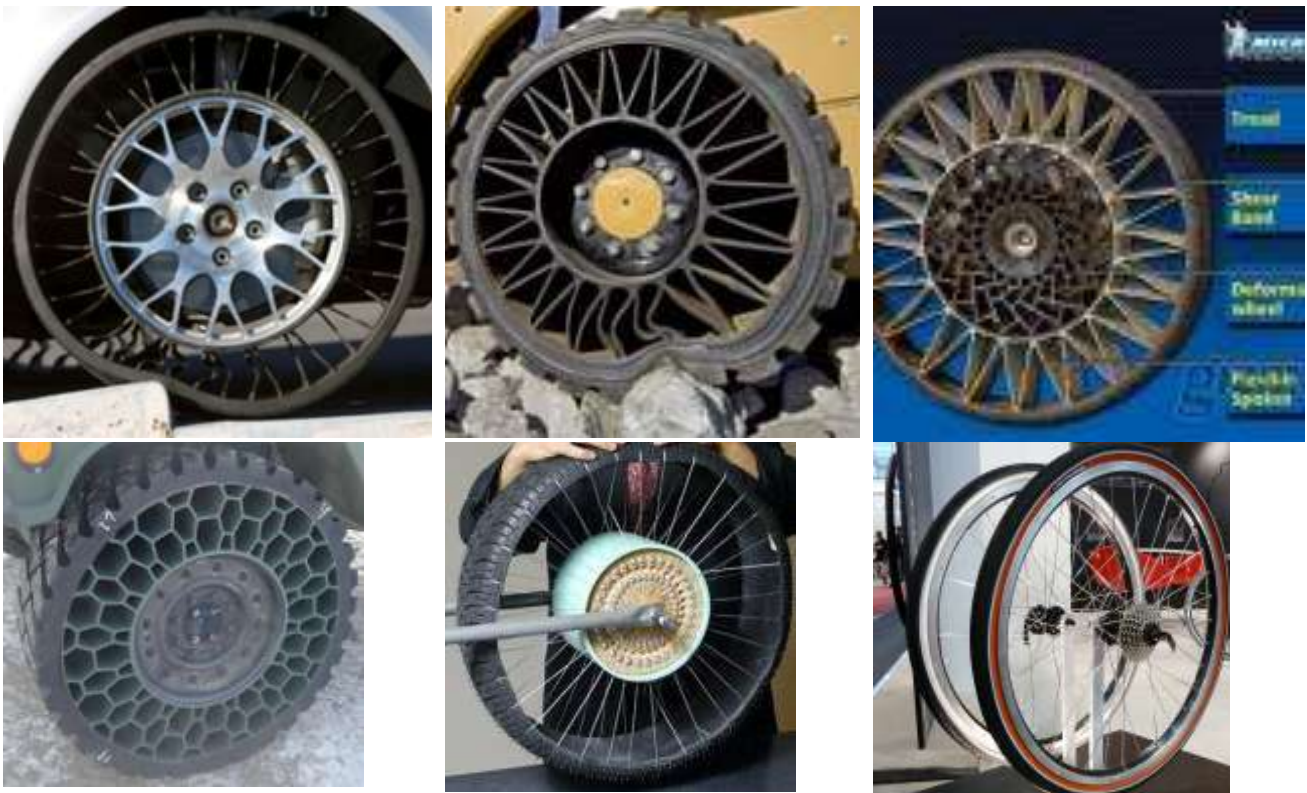
Рис. 4. Современные безвоздушные колесные движители
