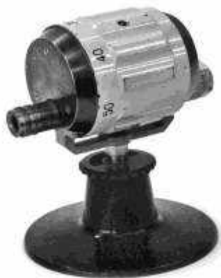
Рис. 1. Внешний вид ступенчатого аттенюатора барабанного типа
