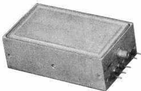
Рис. 9. Аттенюатор электрически управляемый с тремя секциями
