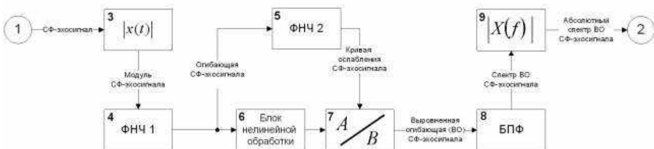
Рис. 2. Этапы дополнительной обработки СФ-эхосигнала
