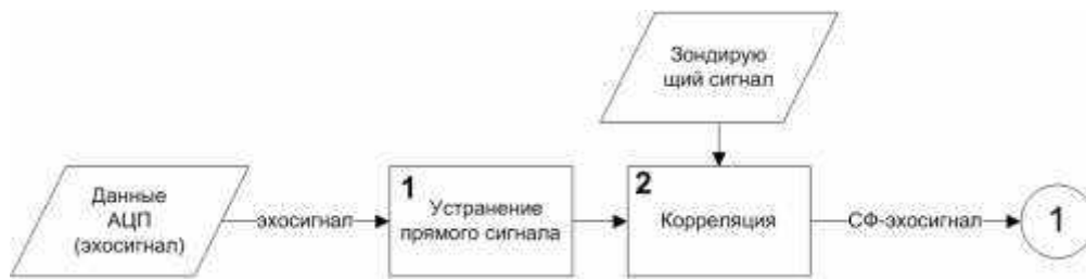
Рис. 1. Этапы предварительной обработки эхосигнала
