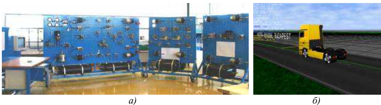
Рис. 1. ПАК для имитации движения большегрузных ТС
