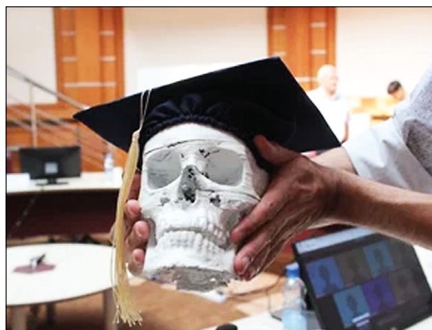
用于使用超声成像研究颅骨中血管的模型。
