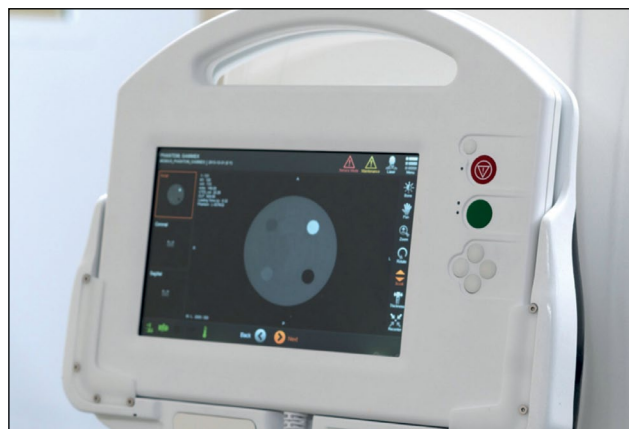
图3. 移动式电脑断层扫描仪Airo TruCT的控制台。
