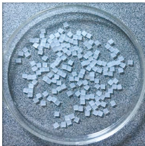
Рис. 1. Термолюминесцентный дозиметр TLD-100® (LiF) (Thermo Fisher Scientific, США).
