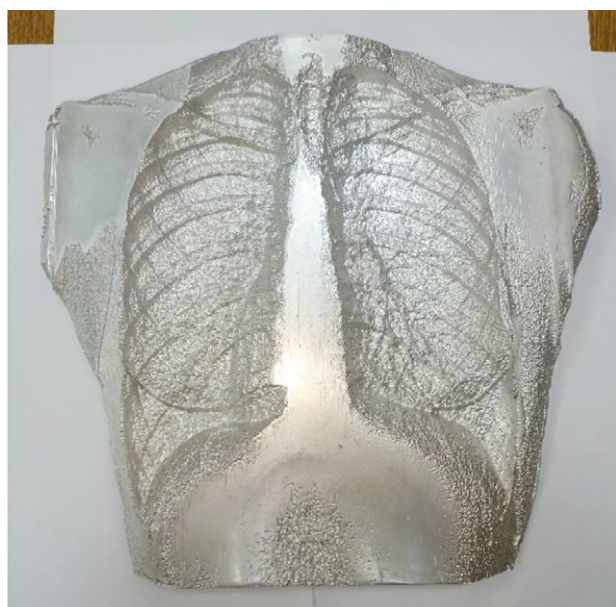
Рис. 4. Итоговый образец разработанного рентгеновского алюминиевого фантома.
