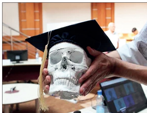
Фантом для исследования сосудов через кости черепа с использованием средств ультразвуковой визуализации.
